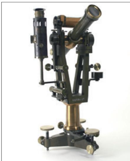
Abb. 2: Grosser Absteckungs-Theodolit für Simplontunnel, um 1898.
