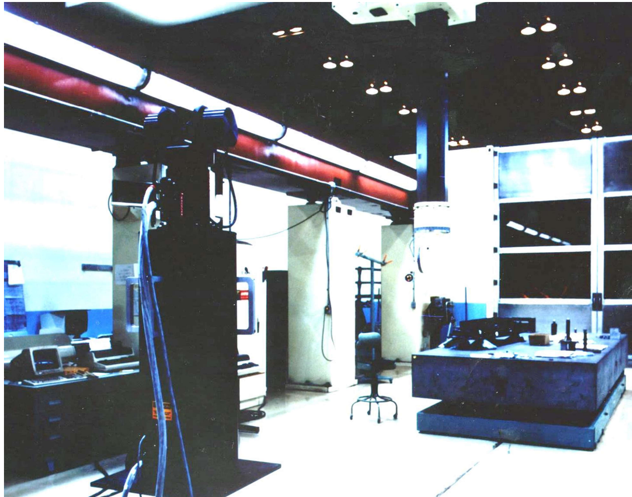
SMART API-Prototyp – Boeing Aircraft Seattle – 3D-Sensor für eine sehr grosse CMM (30mx10mx8m)
