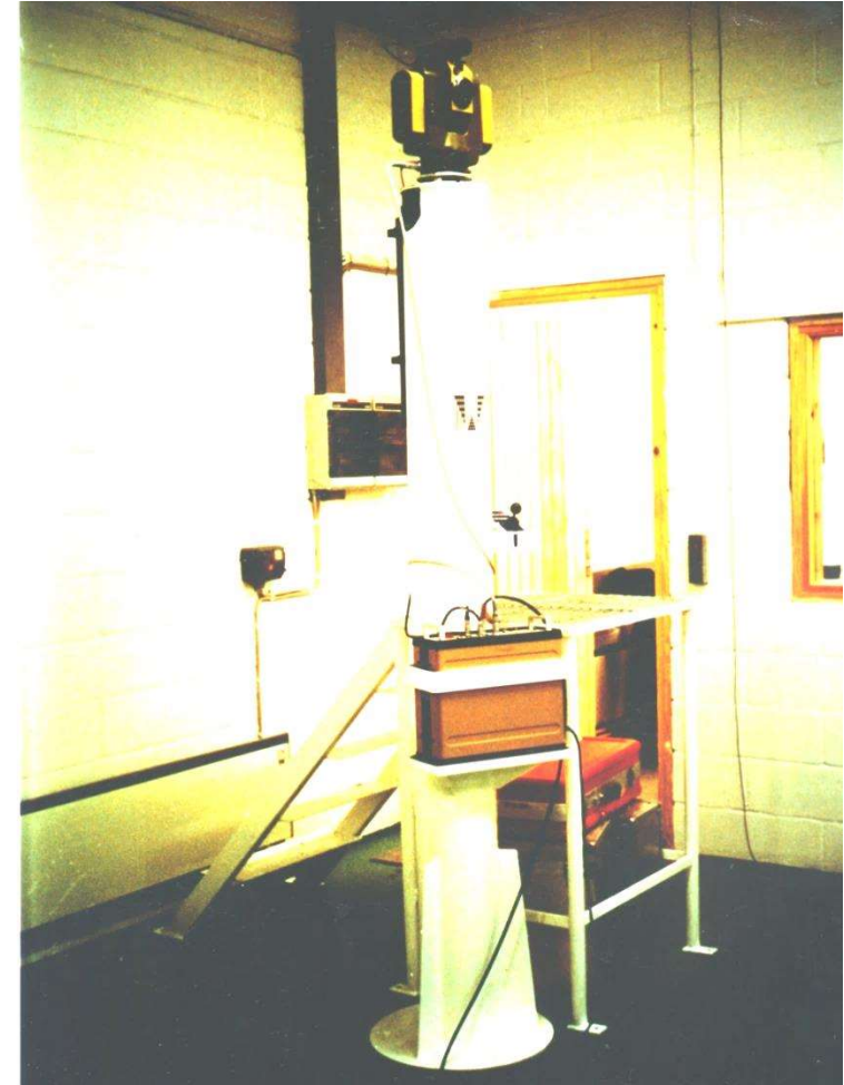
KERN SPACE – Grosser Belt Tunnel – Vollautomatische Fertigungskontrolle von Tübingen
