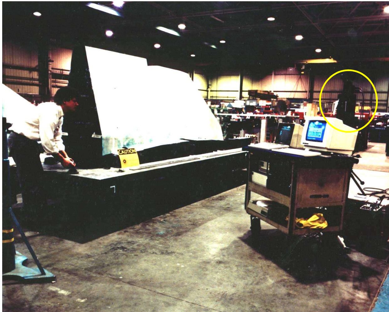
SMART API-Prototyp – Boeing Aircraft – Oberflächenscan von Flügel-Mock-Up's (B747)
