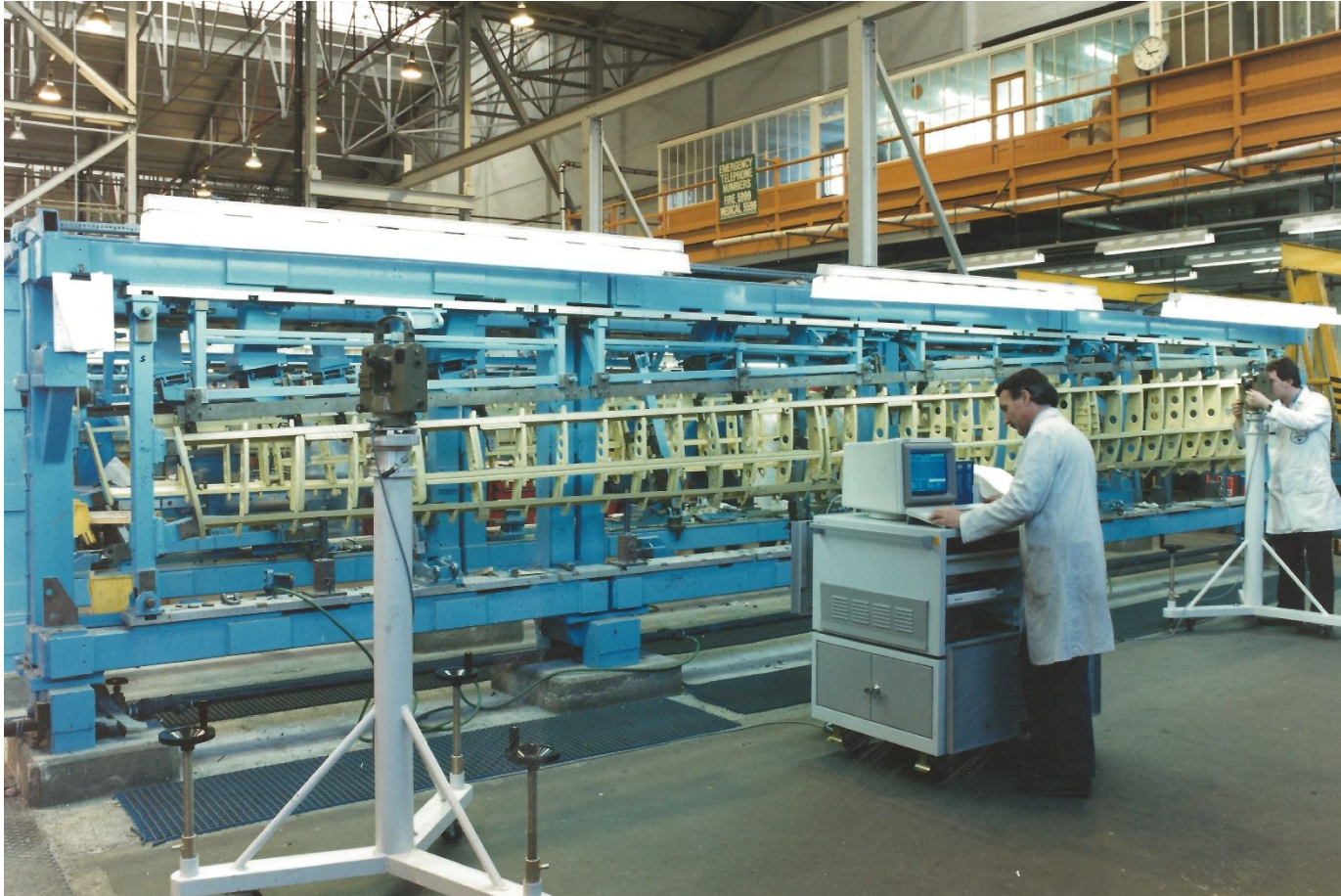
Geometriekontrolle an einer Flügellehre (Airbus A320) mit ECDS, der Vermessungsingenieur geht zum Messobjekt
