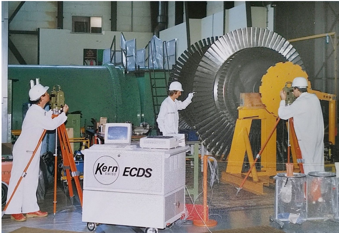
Positionskontrollen an den Schaufeln der KKL Niederdruck-Turbine mit 4 Theodoliten um das Objekt.
