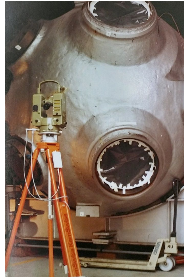
Ein- und Austrittsstutzen am DE mit bearbeiteten Schweisslippen
