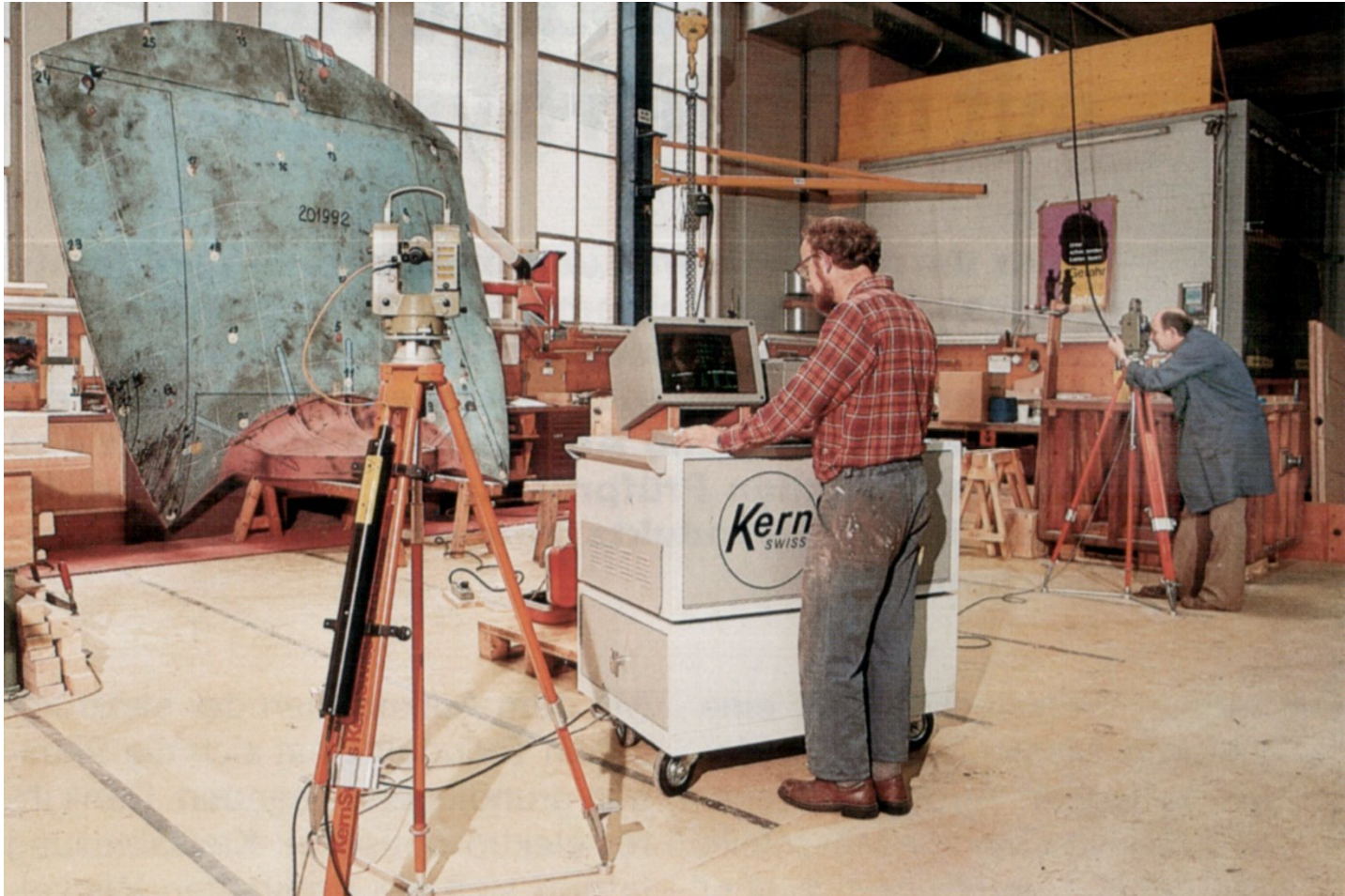
Geometriekontrolle an einer Giessform der Schaufel einer Kaplan-Turbine
